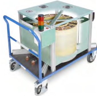
Prüffeld-Lastdrossel 250mH, I_s 500 A, I_{eff} 40 A
