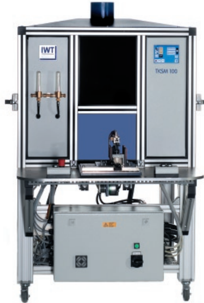
Rechnergesteuerte WIG-Kernschweißmaschine in der BREMER Produktion
